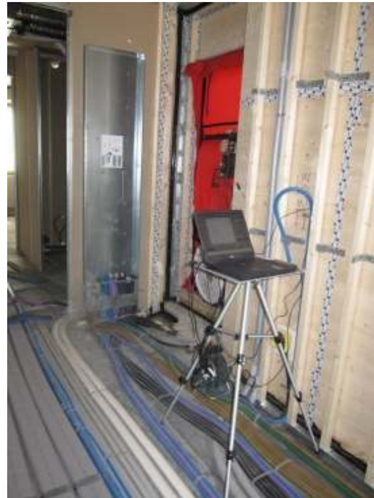
Blower door test di verifica tenuta aria involucro grezzo
