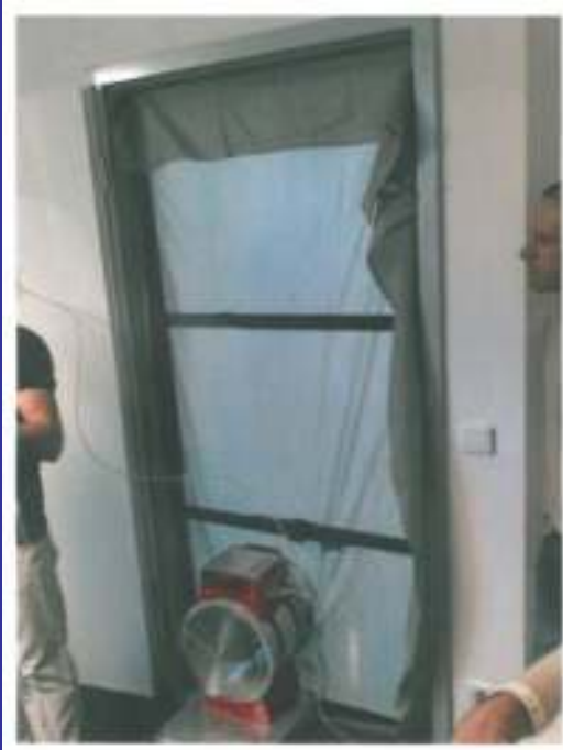
Tenuta all'aria BLOWER-DOOR TEST
