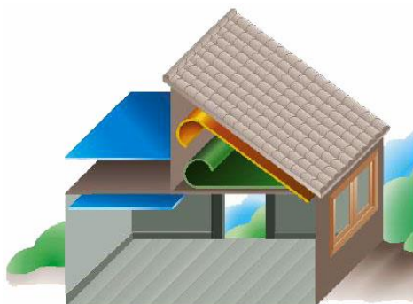
Isolamento della copertura
