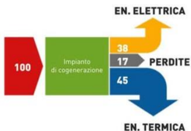
Schema funzionale di un impianto cogenerativo
