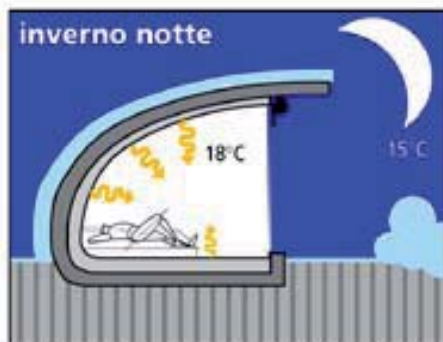
Riscaldamento radiante con energia solare accumulata
